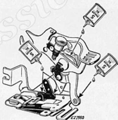
Fig. 95 A. Oiling Points on Ruffler
